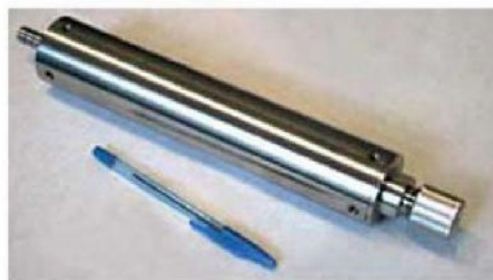
Рис.3. Преобразователь гидростатического давления и температуры кварцевый ПДТК-Р-МГ. Совместная разработка с ЗАО "Авангард-Элионика" г. Санкт – Петербург.
