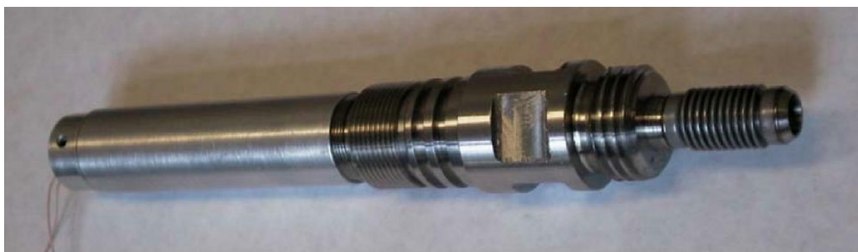
Рис.4. Прецизионный кварцевый преобразователь давления и температуры ПДТК-60.0-МС-10 (опытный образец). Габариты: 0 32 x 217 мм, корпус - нержавеющая сталь. Диапазон рабочих давлений: 0...40,0; 60,0 МПа. Диапазон рабочих температур: -20...+ 135 °С. Нелинейность < 0.5 %. Погрешность измерения с температурной компенсацией %: 0,06; 0,1; 0,15, 0,25
